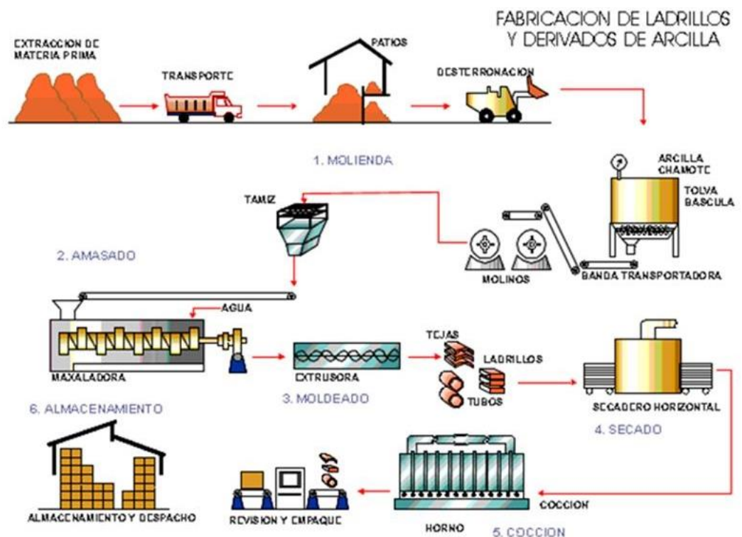
Figura 7. Ejemplo del Proceso de fabricación de ladrillos
