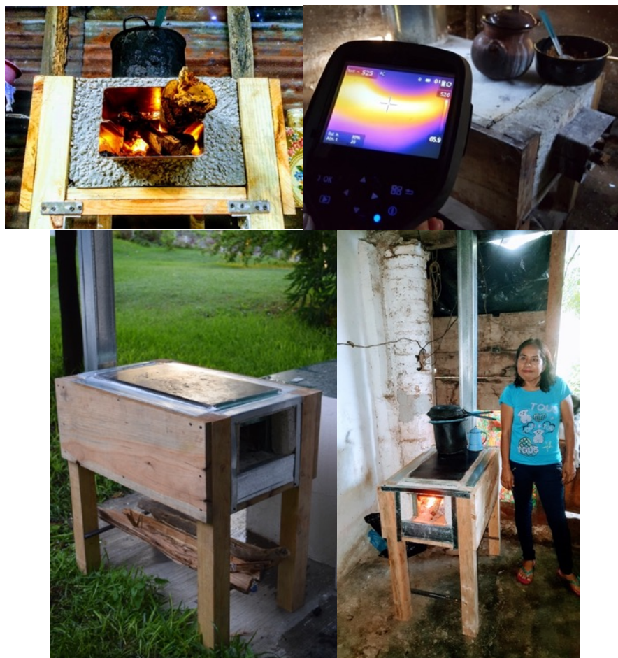
Figura 24. Estufas Enerchía (arriba) y Ecochía (abajo) instaladas y funcionando
