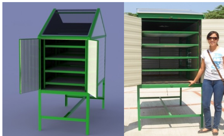
Figura 14. Secador Solar Multipropósito hecho con materiales térmicos prefabricados. Modelo y Foto: O. García-Ramos
