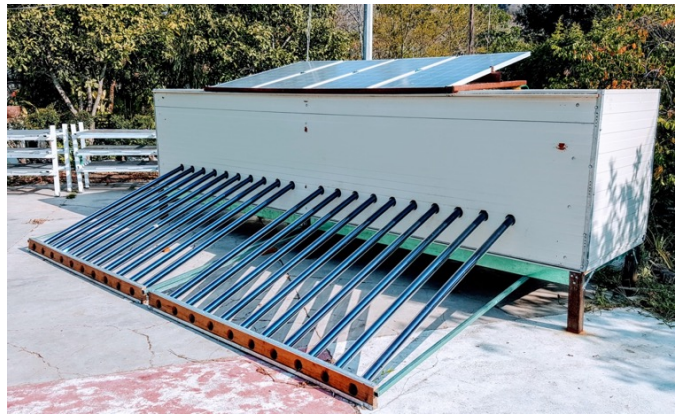
Figura 20. Secador Solar para Mango Ataulfo de 5 m 3 implementado en La Concordia, Chiapas. Foto: J. Moreira-Acosta.
