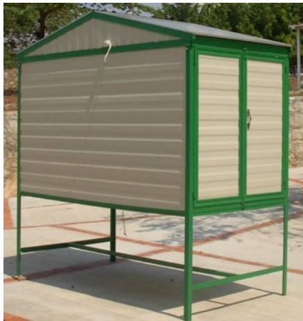
Figura 17. Secador Multipropósito hecho con módulos prefabricados. Foto: O. García-Ramos.
