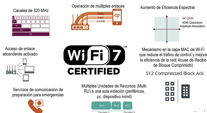
Figura 40. Características técnicas de Wi-Fi 7
