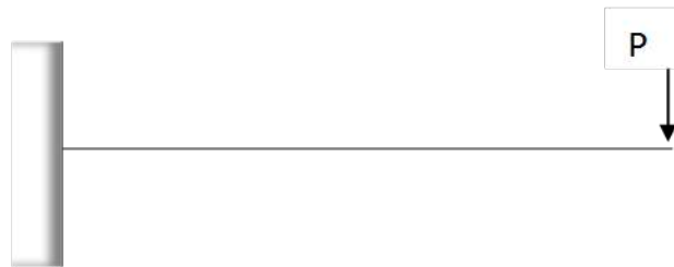
Figura II.13.- Esquema de ensayo a flexión por consola
