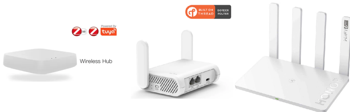
Figura 1.22 Componentes típicos de la capa de networking. De izquierda a derecha encontramos un gateway Zigbee, Border router Thread y un router Wifi 6. Elaboración propia.
