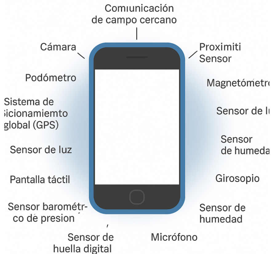
Figura 1.17 Ejemplo de sensores integrados en un smartphone. Elaboración propia.
