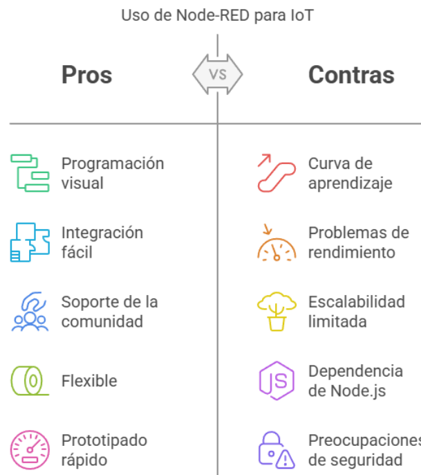
Figura 3.14 Evaluación de los pros y contras de Node-RED en la implementación de soluciones IoT. Elaboración propia.
