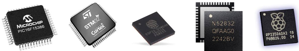
Figura 1.20 Ejemplo de algunos procesadores que encontramos la capa de dispositivos. De izquierda a derecha encontramos un PIC, STM32, ESP32, NRF52 y Rpi. Elaboración propia.
