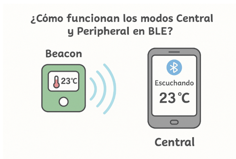
Figura 1.33 Comunicación de un sensor inteligente de temperatura usando un Beacon BLE. Elaboración propia.
