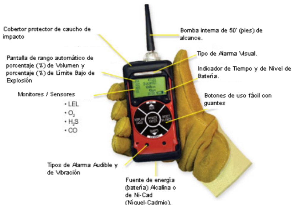
Figura 8: Detector de atmosfera inflamable
