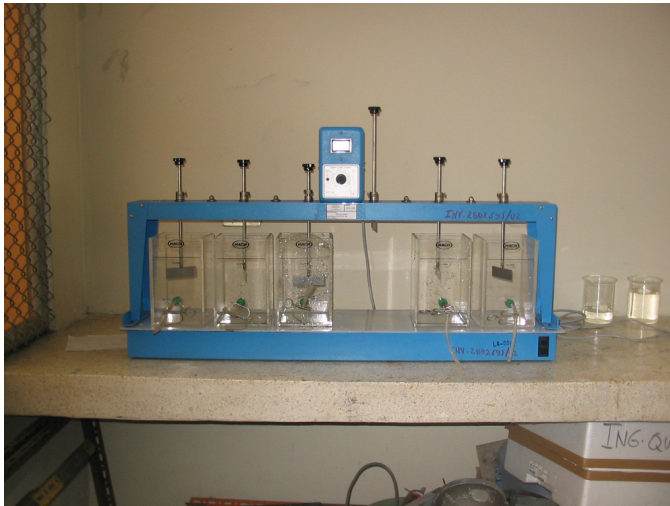
Figura 27. Equipo para la realización de la prueba de las jarras- Fuente: Elaboración propia.
