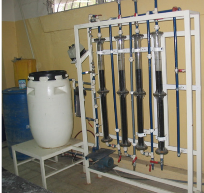
Figura 17. Columna de adsorción con carbón activado granular. Fuente: Autoría propia.
