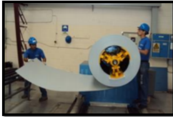
Figura 5. Des bobinado. Realizado por Gayrey T., 2018.
